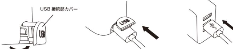
1 本体のUSB接続部カバーを下から押し上げるように外してください。
