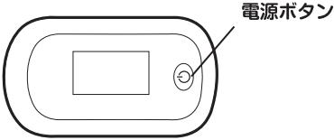
電源が入っているときに電源スイッチを1秒以上長押しすると、画面表示の明るさを調節することができます。明るさは10段階あり、初期設定値はレベル4です。ボタンを長押しするとレベルが順番に表示されますので設定したい明るさのレベルが表示されたらボタンを離して設定完了です。
