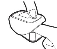
5. 測定信号が安定して約 8 秒で、測定値と脈波波形が表示されます。
