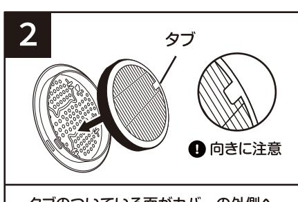
タブのついている面がカバーの外側へくるようにフィルターをカバーに取り付けてください。
