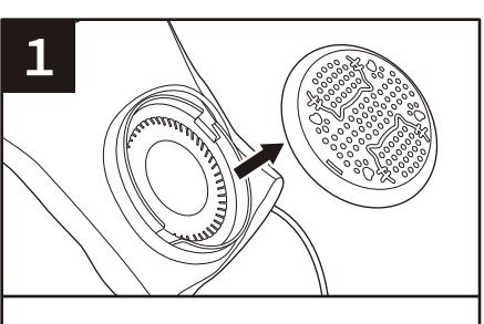
カバーを反時計まわりの方向へ回して取り外してください。
