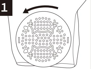
カバーを反時計まわりの方向へ回して取り外してください。
